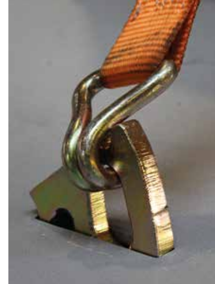
Bodenblechzurrösen: Verzinkte, klappbare Zurrösen ermöglichen die Kombination von Paletten- und Schüttguttransport.
