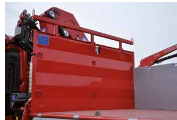
Stirnwandzurrösen garantieren sicheres Verzurren von Baggerschaufeln und Geräten an der Stirnwand.
